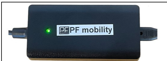
Bij de aansluiting en aan het einde van het laadproces brandt de led groen.
